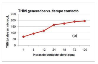
Figura 1. Ensayos prácticos de potencial de formación de THM del agua bruta: (a)frente a la dosis de cloro (2 horas de contacto); (b)frente al tiempo aplicando dosis de 3 mg/L.
